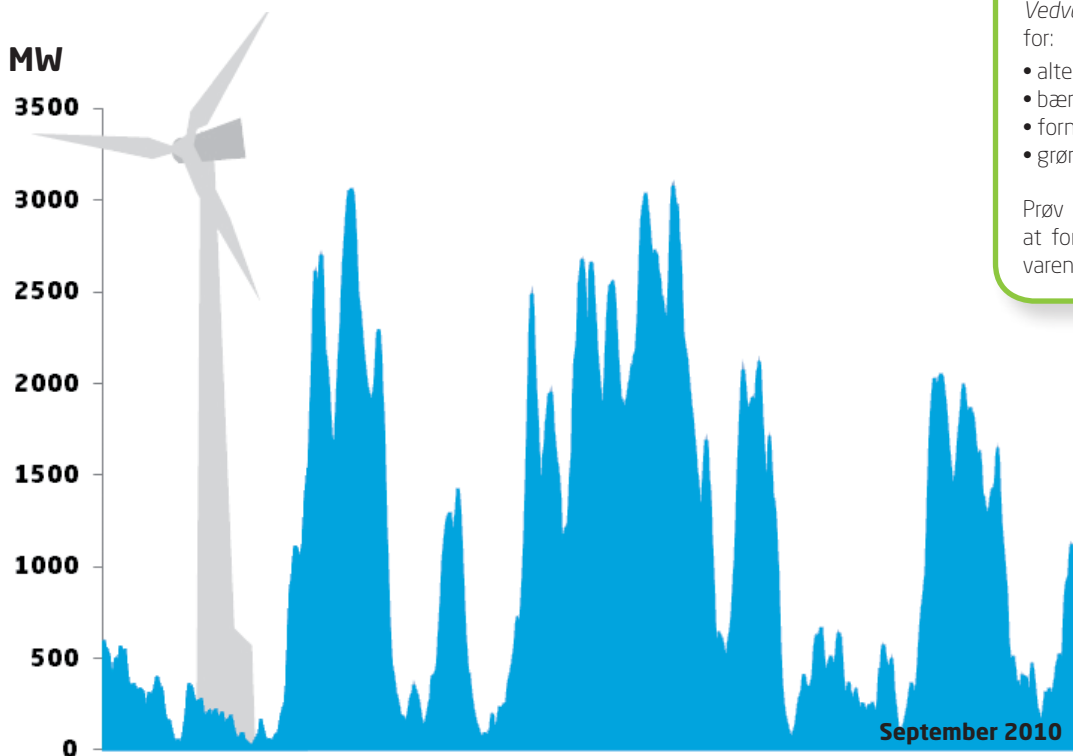
Variationen i dansk vindkraft. Elproduktionen fra vindmøller varierer, fordi vindstyrken skifter fra dag til dag. MW betyder megawatt.
